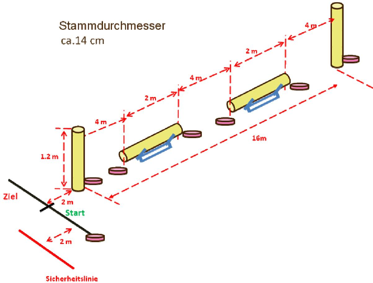
An den Rundholzstämmen werden für den Schnittbereich vier 5 cm breite Bänder gemalt, innerhalb deren der Schnitt geführt werden muss Abb. 47
