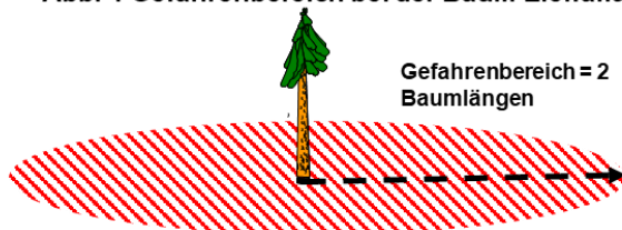
Abb. 4 Gefahrenbereich bei der Baum-Zielfällung
